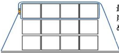
最上層に膨らみをもたせて安全に覆い、ブレーキによって貨物の中心が前に荷崩れするのを止めることができます。ピラミッド型に積み重ねる必要がないため、積載量を最大にします。
